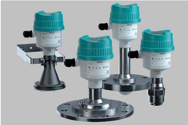
Die Baureihe SITRANS LR500 umfasst 80 GHz-Radar-Füllstandmessumformer für Messbereiche bis 120 m (393 ft). Sie eignen sich für die kontinuierliche Überwachung von Flüssigkeiten, Schlämmen und Schüttgütern in Lager- und Prozessbehältern mit hohen Temperatur- und Druckwerten.
