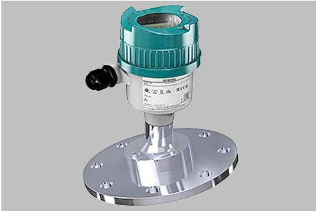
Der SITRANS LR580 mit Linsenantenne ermöglicht die kontinuierliche Überwachung von Schüttgütern oder Flüssigkeiten für Messbereiche bis 120 m (394 ft). Er umfasst einen Verstellflansch sowie einen integrierten Spülanschluss (Luft) für Bestandsmessungen in Silos. Er eignet sich auch gut für Hochtemperaturanwendungen in der Zement- und Energieindustrie.
