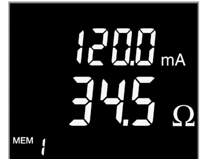
Standardmodus: Impedanz und Fehlerstrom
