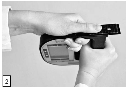
Abb. 11: Entfernen der Pumpenverriegelungsschraube (1) und der Pumpenverriegelung (2)
