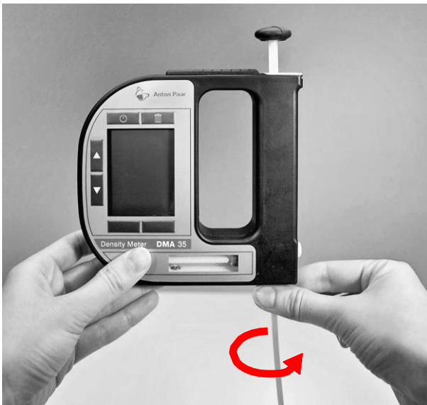
Abb. 5: Anschluss des Füllrohrs
