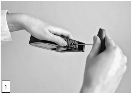
Abb. 11: Entfernen der Pumpenverriegelungsschraube (1) und der Pumpenverriegelung (2)
