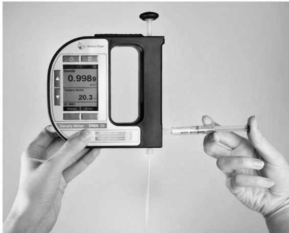
Abb. 8: Befüllung der Probe mit der Kunststoffspritze
