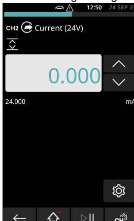
Abbildung 4-12: Quellstrom auf CH2 mit interner Stromschleife (Bereich: 0 bis 24mA)
