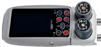
Abbildung 1-1: DPI620G mit MC620G-Modulträger und PM620-Druckmodulen
