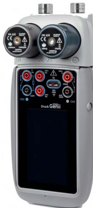
Abbildung 5-2: DPI620G mit MC620G-Modulträger und PM620-Druckmodulen
