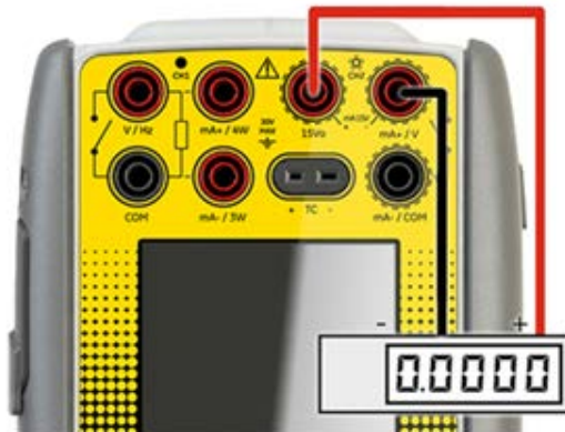
Abbildung 4-15: Verbindungen für unregulierte 15Vo-Stromschleifenausgänge
