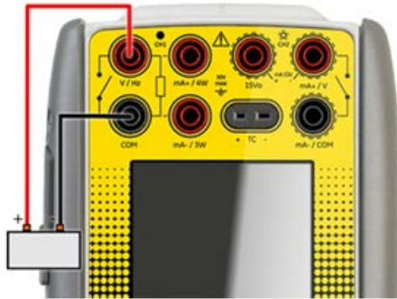
Abbildung 4-5: Messen Sie Gleichspannung oder Gleichstrom mV auf CH1, Bereich \pm 30 V
