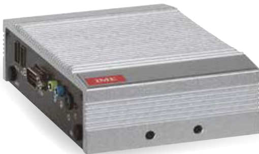
Webserver für 255 Modbus Adressen oder 255 Impulsmodule (Best.Nr. SXWS255).
