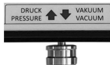
Druck-/Vakuum-Umschalter eingedrückt = Druck herausgezogen = Vakuum
