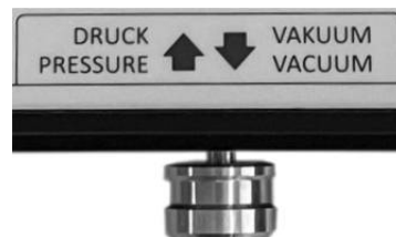
Druck-/Vakuum-Umschalter eingedrückt = Druck herausgezogen = Vakuum
